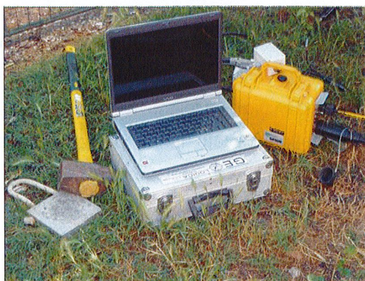
Fig. 3 – Particolare della strumentazione utilizzata per le indagini sismiche.
